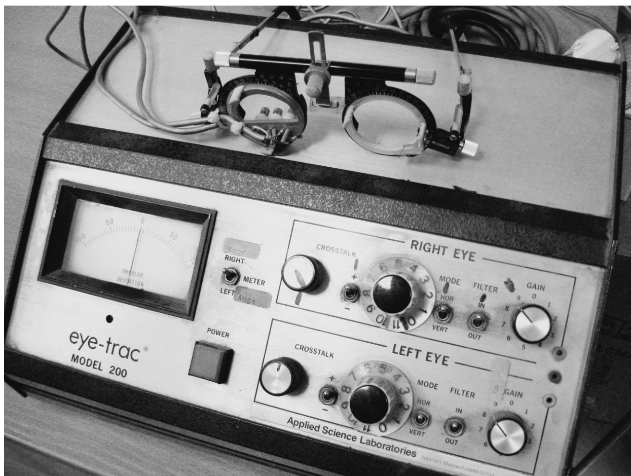
Рис. 5. Установка для фотооптической регистрации движений глаз (горизонтальная составляющая) eye-track model 200 – 1978 г. (оборудование предоставлено В. И. Белопольским, ИПРАН)
